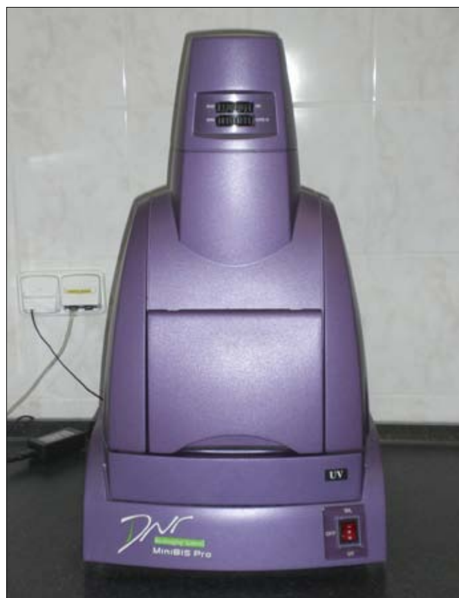
UV transluminátor (zviditelňující fragmenty DNA na agarózovém gelu)
